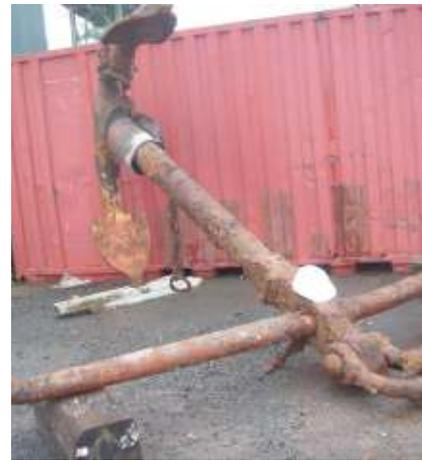
Sortir l'ancre de la terre (la pelle de l'excavatrice mesure environ deux mètres de large). Les ancres sont fabriquées pour des classes spécifiques de bâtiments et sont classées selon leur poids. Le *Niobe* était le seul bâtiment canadien assez gros pour avoir besoin d'une ancre de cette taille.
