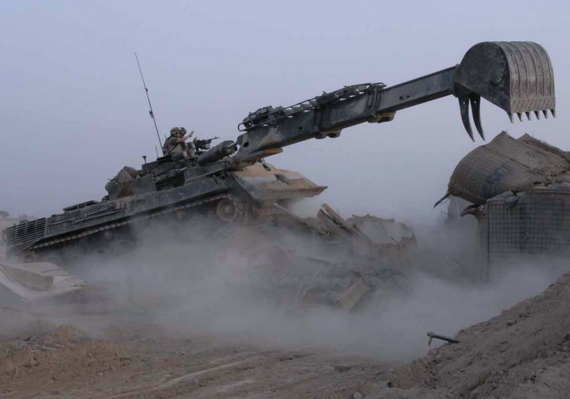
(Top) The multi-purpose Badger using its arm to clear debris. It is also equipped with a blade for earth works and clearance. / (Ci-dessus) Le véhicule utilitaire Badger utilisant son mât pour l'enlèvement des débris. Il est aussi équipé d'une pelle avant pour déplacer la terre et déblayer.
